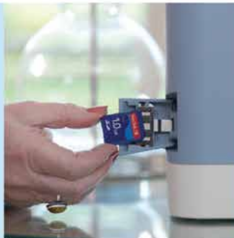
Tarjeta SD para almacenar hasta 1 año de datos de ventilación.
